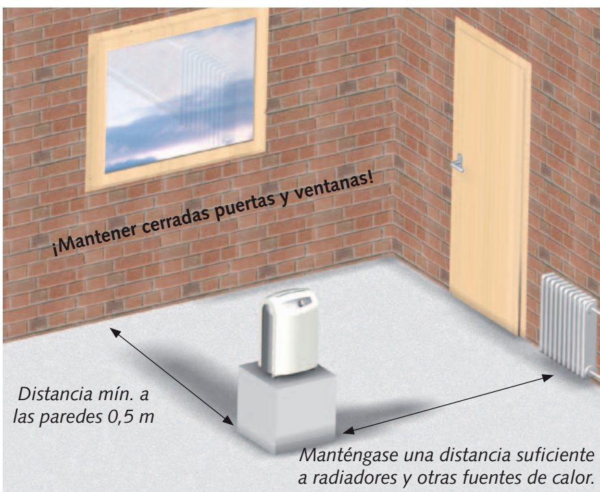
Fig.2 Representación esquemática de la instalación del deshumidificador
